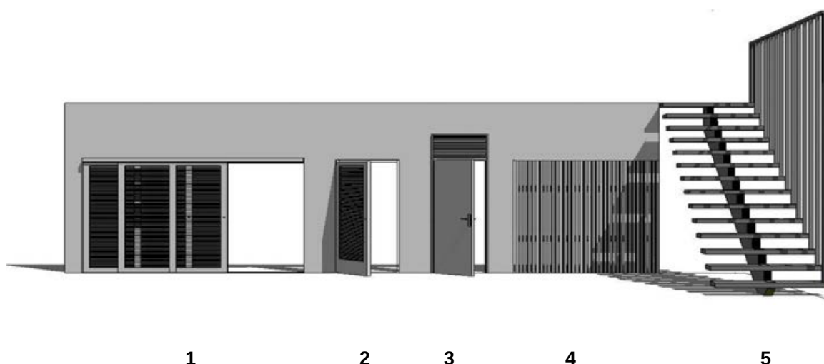
Figure 14 : exemples de traitement des cloisons et ouvertures intérieures situées perpendiculairement aux écoulements transversaux du flux d'air : panneaux coulissants(1), portes ajourées à lames (2), impostes ajourés (3), claustras (4), escaliers sans contre-marche (5).
