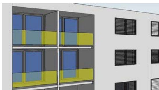
Figure 40 – Autre solution : Organisation du bâtiment avec un positionnement adapté des espaces extérieurs (loggias). En présence de garde-corps étanches à l'air, vérifier si le taux d'ouverture en façade est respecté (voir § 2.4.)
