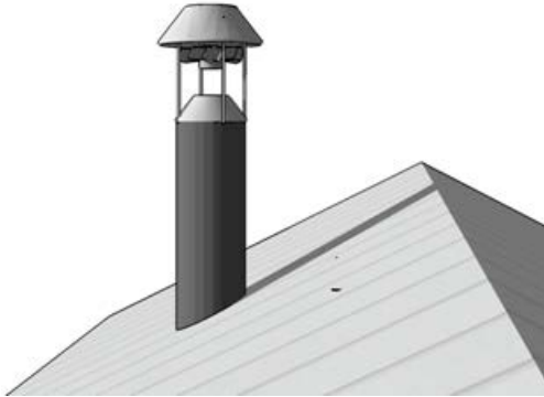
Figure 61 – Extracteur pour ventilation naturelle assistée, positionné au sommet du conduit en sortie de toiture
